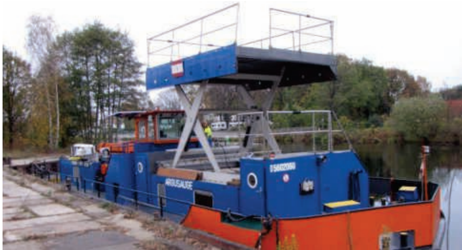
Abb. 6 - Prüfschiff Argusauge zur Bauwerksprüfung von Ingenieurbauwerken, Quelle: © SenMVKU
